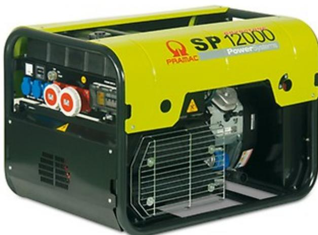
Dieser Stromerzeuger erfüllt die höchsten Ansprüche hinsichtlich Personenschutz (Isolationsüberwachung), Geräteschutz (Schutzklasse IP 54), Anlaufstromverhalten (elektronisch geregelter Synchrongenerator 4-fach I-Nenn) und Schiefastauglichkeit (unterschiedliche Belastung der einzelnen Phasen).
